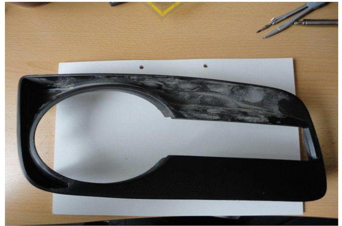
Nach ausmessen und anzeichnen der TFL habe ich die Einlässe mittels eines 3mm Holzbohrers schräg vorgebohrt.
