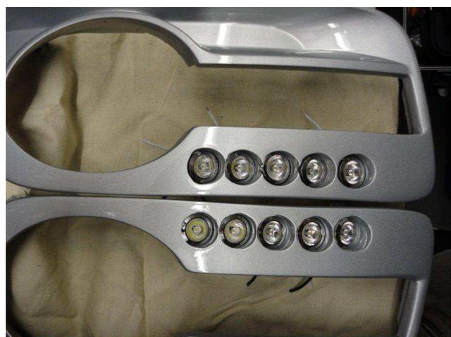
Nach dem einsetzen der TFL- LED's habe ich die abgeschnittenen Kabel wieder mit den Original Steckverbindungen verlötet und mit Schrumpfschlauch gegen Feuchtigkeit gesichert. Außerdem wurden die Rückseite gegen Feuchtigkeit mit Silikon versiegelt.
